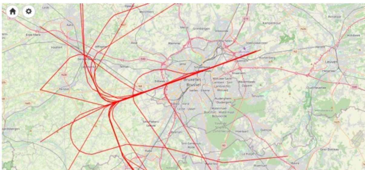
Tracés radar des 18 atterrissages en mode RNP vers la piste 07R les 11 et 20 août 2020
