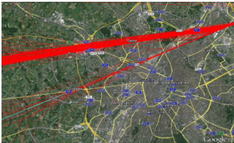
Comparaison entre les tracés radar en mode VOR (approche courbe) et en mode RNP (descente continue)
